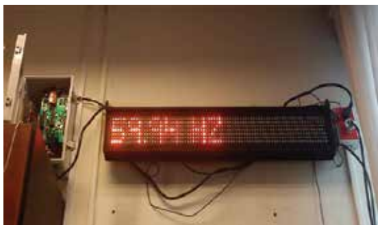
Figura 1: Registrador de frecuencia instalado en el centro de contacto de la CENTROSUR
