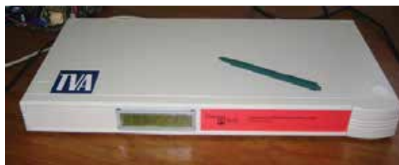
Figura 19: Registrador de disturbios de frecuencia [5]
