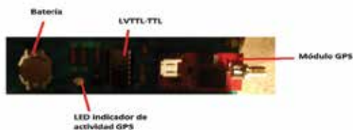
Figura 9: Ubicación del módulo GPS en la placa de control
