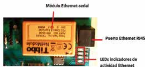
Figura 10: Ubicación del módulo Ethernet-serial en la placa de control
