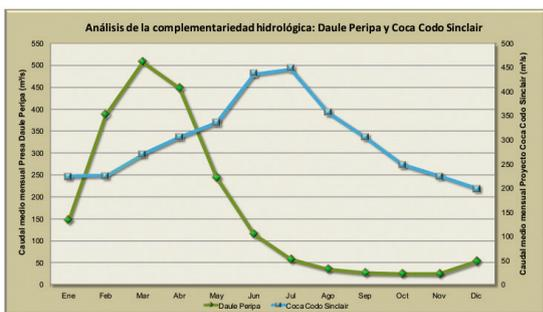
**Figura 3: Complementariedad hidrológica entre la vertiente del Pacífico (represa Daule Peripa en la planta Marcel Laniado de Wind) y la vertiente del Amazonas (Planta Coca Codo Sinclair). Fuente: [10]**
