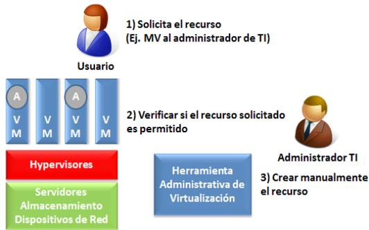
Figura 2: Virtualización en esquema tradicional
