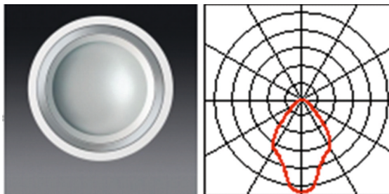
Figura 8: Patrón de iluminación de las luminarias LED utilizadas en la simulación
