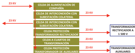
Figura 2: Celdas de Corriente alterna en 23 kV
