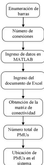
**Figura 6: Ubicación de PMUs mediante observabilidad estática**
