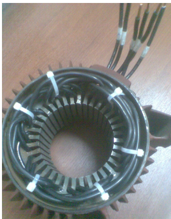
Figura 6: Fotografía del devanado estatórico del prototipo
