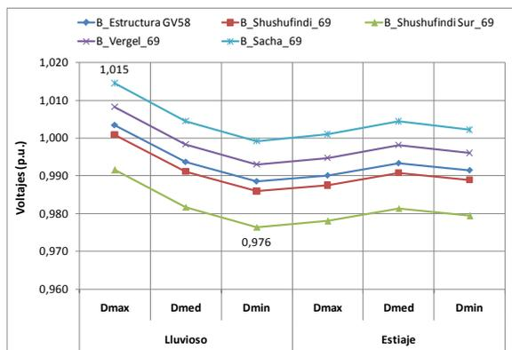
Figura 6: Voltajes en Barras del SEIP-E - Año 2017 CON Interconexión
