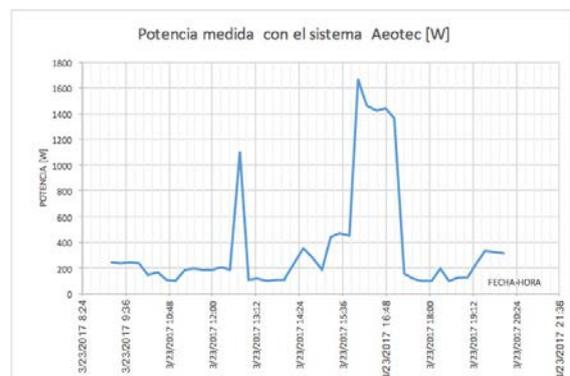
Figura 6: Grafica de Potencia Obtenida de los Datos Capturados por el Medidor Inteligente AEOTEC
