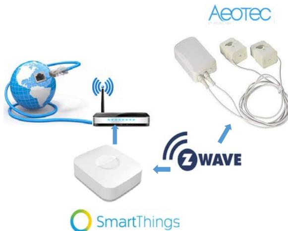
Figura 4: Arquitectura del Sistema Medidor de Energía empleando Equipos Samsung y AEOTEC
