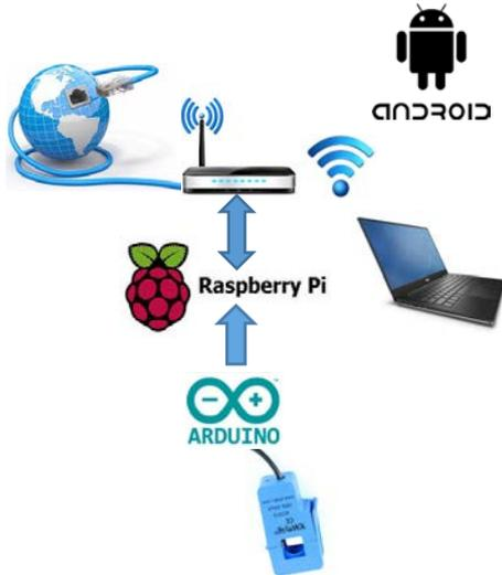
Figura 1: Arquitectura del Sistema Medidor de Energía Eléctrica Propuesto
