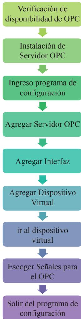
Figura 5: Procedimientos de configuración de los Servidor OPC
