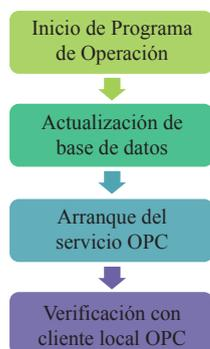
Figura 6: Procedimientos de arranque de servidor OPC
