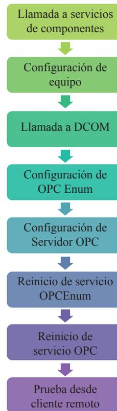
Figura 7: Procedimiento para la configuración de seguridades
