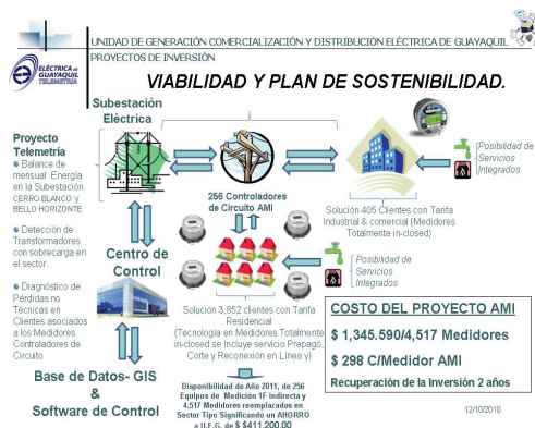
Figura 2: Esquema básico del Sistema AMI de UEG
