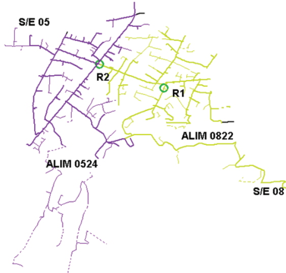
Figura 5: Red de Media Tensión (22 kV) Alimentador 0822
