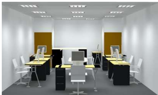
Figura 9: Imagen 3D en DIALux del sistema de iluminación repotenciado
