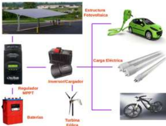
Figura 1: Esquema general de la electrolinera solar aislada en la Universidad Técnica de Ambato.
