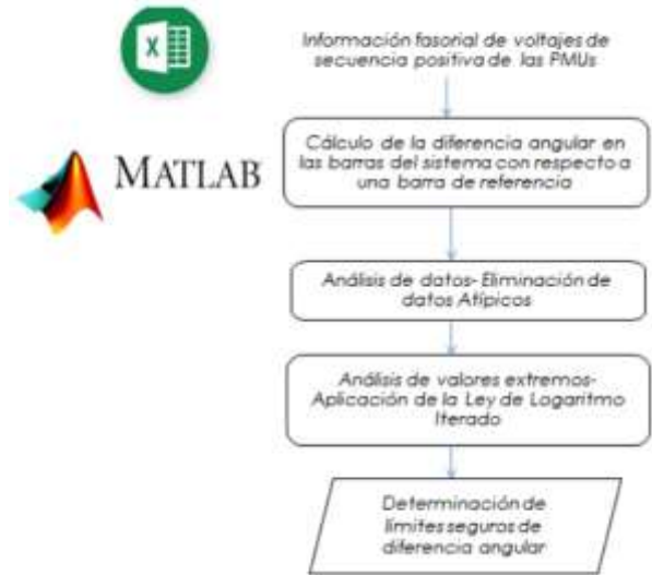
Figura 8: Diagrama de flujo de la metodología empleada para determinar límites seguros de estabilidad estática de ángulo
