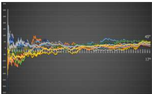
Figura 10: Gráfico del comportamiento de la diferencia angular entre Coca Codo Sinclair – Pascuales empleando la Ley de Logaritmo Iterado – Datos del 2017.
