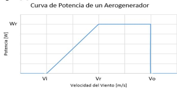
Figura 2: Curva Típica de Potencia de un Aerogenerador
