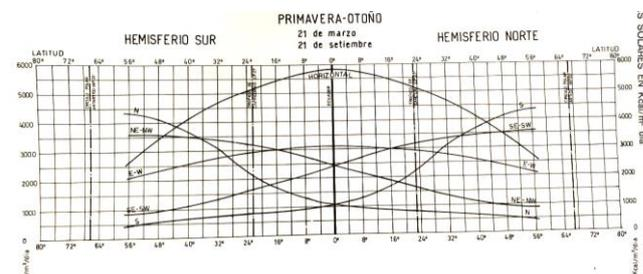
Figura 2: Radiaciones solares en kcal/m<sup>2</sup> día – Equinoccios. [15]
