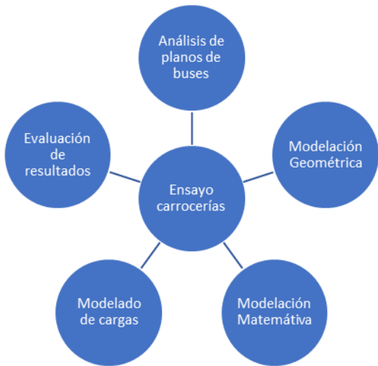
Figura 1. Metodología de ensayo estructural de autobuses
