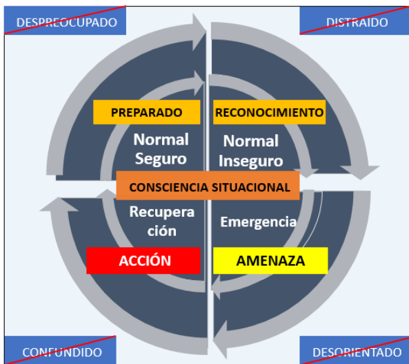
Figura 2: Estados de un Sistema de Potencia y los Mecanismos de Consciencia Situacional Deseables
