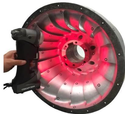
**Figura 4: Ingeniería inversa, colocación de targets y escaneo sobre un rodete de la turbina Francis.**
