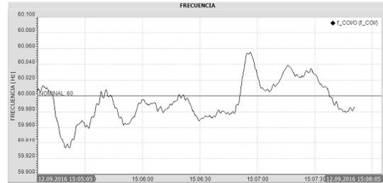
**Figura 7: Monitoreo de la frecuencia promedio del sistema, en tiempo real, con la interfaz gráfica de WAProtector**
