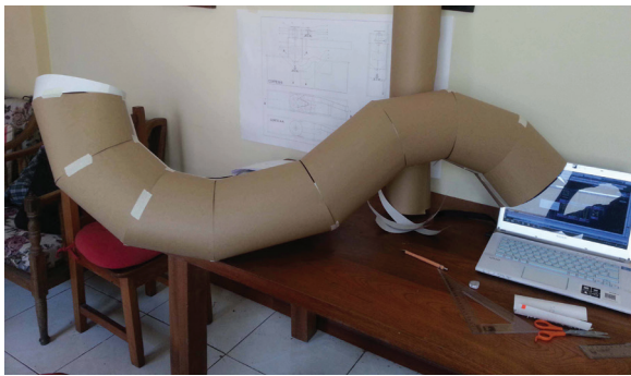
Figura 8: Moldes para construcción del sifón
