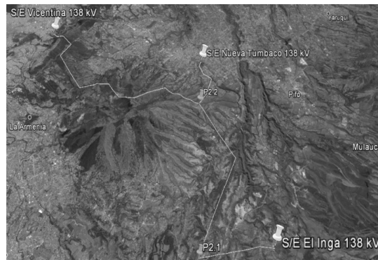
Figura 2: Trayectoria de la alternativa 2, delimitada por las subestaciones El Inga y Vicentina, que considera la derivación hacia la subestación Nueva Tumbaco.
