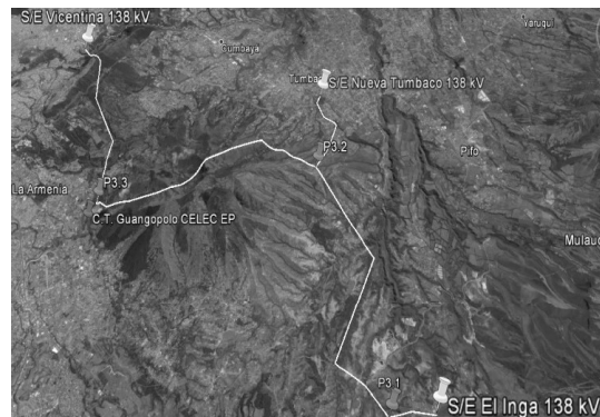
Figura 3: Trayectoria de la alternativa 3, delimitada por las subestaciones El Inga y Vicentina, que considera la derivación hacia la subestación Nueva Tumbaco
