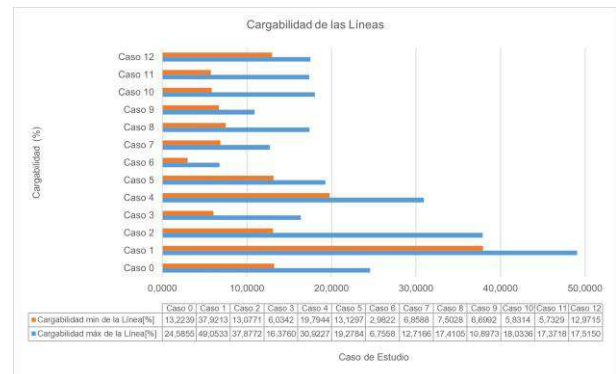
Figura 5: Cargabilidad de las Líneas de Distribución en los 12 Casos en la Red de Baja Tensión. [1]
