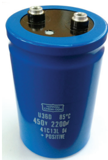
Figura 9: Vista del condensador del bus CC
