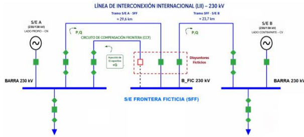
Figura 5: Diagrama Unifilar del Modelo Propuesto.
