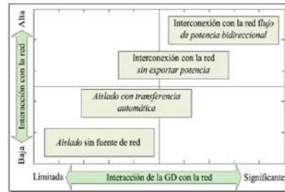
Figura 4: Modelos de interacción con la red por el modo de interconexión de la GD [11]
