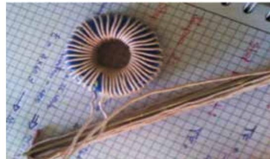
Figura 17 : Inductor bobinado con cable Litz
