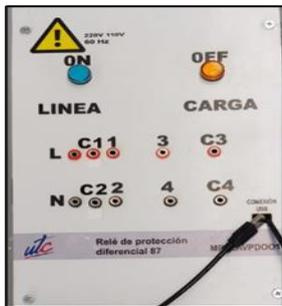
Figura 7: Diseño de la parte delantera de la caja del Relé Diferencial
