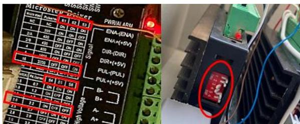
**Figura 17: Configuración de controlador de motor (TB6600)**
