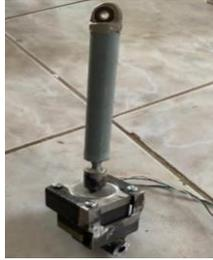
Figura 4: Actuador Lineal [Los autores, 2023]
