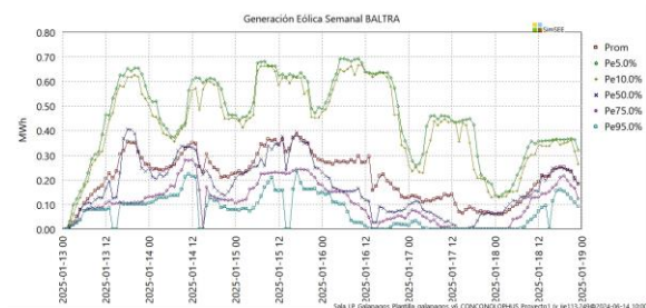
Figura 10: Perfil horario de generación eólica en Baltra para la segunda semana del 2025, con corte de probabilidad en excedencia de 5%, 10%, 50%, 75%, 95%
