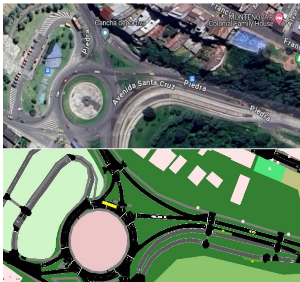
Figura 3: Comparación entre imagen satelital y red vial modelada en SUMO
