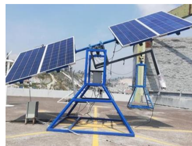
Figura 3: Implementación Física del Sistema de Seguimiento Solar en la Terraza del Bloque B (UTC – Matriz)
