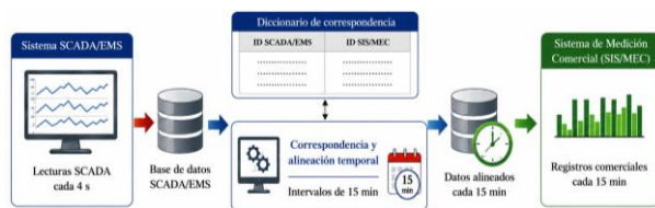
Figura 2: Esquema de alineación temporal entre telemetría SCADA/EMS y registros comerciales
